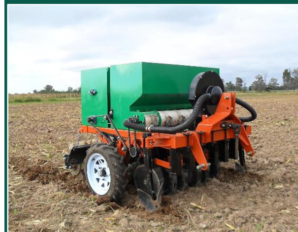
Sembradora de precisión para frijol, diseñada en el Campo Experimental Pabellón del INIFAP. Facilita la siembra en camas con hasta seis hileras.
